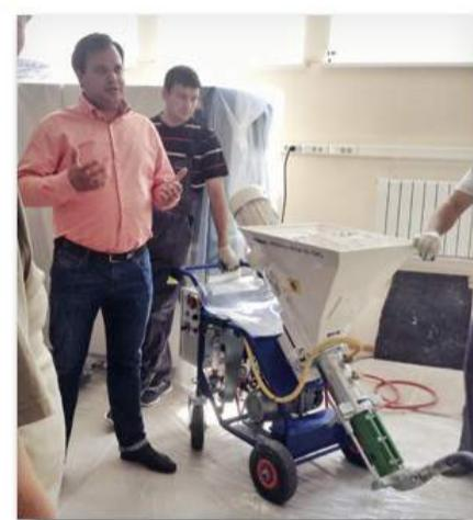
В НИИ «МГСУ» прошла презентация уникальной штукатурно-шпаклевочной станции m-tec mono mix на 220В, предназначенной для выполнения отделочных работ. Уникальность её заключается в возможности подачи всех типов штукатурных, шпаклевочных и клеевых растворов, при этом оборудование работает от бытовой сети 220В. На презентации присутствовала специальный корреспондент издательства «Стройиздат» Дарья Березкина.
